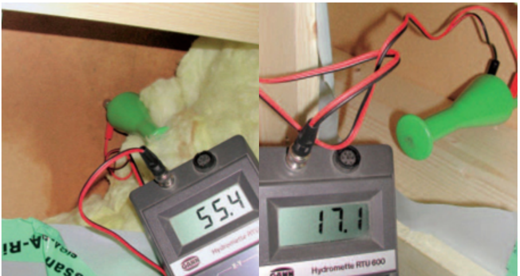
Figuur 5 - vochtmetingen achter de isolatielaag.
